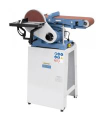
Das Modell BDSM 230 C ist eine besonders wirtschaftliche und in der Anschaffung günstige Schleifmaschine. Durch die Kombination von Band- und Tellerschleifmaschine können nahezu alle in der Werkstatt anfallenden Schleifarbeiten erledigt werden.
