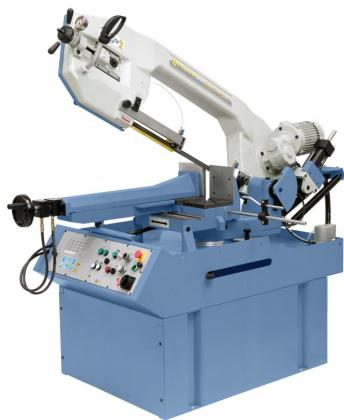
Das Modell MBS 530 DGA-V ist eine halbautomatische Doppelgehrungsbandsäge für Gehrungsschnitte bis 60°. Die stufenlose Schnittgeschwindigkeit sowie der hydraulische Schraubstock ermöglichen ein komfortables Arbeiten. Dieses Modell garantiert durch ihre solide Bauweise ein präzises Schnittbild beim Schneiden von Hohlprofilen, Vollmaterialien, Edelstahl, Werkzeugstahl usw.
