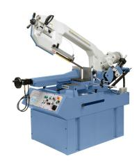
Das Modell MBS 530 DGA-V ist eine halbautomatische Doppelgehrungsbandsäge für Gehrungsschnitte bis 60°. Die stufenlose Schnittgeschwindigkeit sowie der hydraulische Schraubstock ermöglichen ein komfortables Arbeiten. Dieses Modell garantiert durch ihre solide Bauweise ein präzises Schnittbild beim Schneiden von Hohlprofilen, Vollmaterialien, Edelstahl, Werkzeugstahl usw. Ihren Einsatzbereich findet diese Maschine in Schlossereien, Reparaturbetrieben, im Formen- und Werkzeugbau, ...
