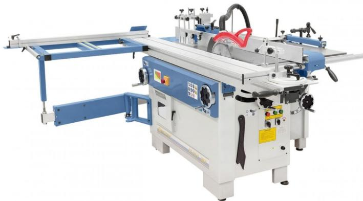
Das Holzbearbeitungszentrum CF 410 F - 2600 bietet dem professionellen Anwender ein Höchstmaß an Einsatzmöglichkeiten und Leistung. Durch die Kombination aus Abricht-, Dickenhobel-, Kreissäge-, Fräse- und Langlochbohrmaschine bietet diese Maschine einen großen Einsatzbereich auf engstem Raum.
