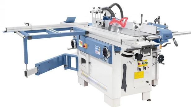
Das Holzbearbeitungszentrum CF 310 F - 2600 kombiniert eine Vielzahl an Bearbeitungsmöglichkeiten (Hobeln, Sägen, Fräsen, Bohren) auf kleinstem Raum. Durch das serienmäßige Vorritzaggregat, den vier Spindeldrehzahlen, der schwenkbaren Frässpindel und vielen weiteren Vorzügen, lässt dieses Modell keine Wünsche offen.
