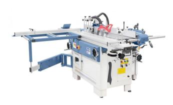
Das Holzbearbeitungszentrum CF 310 F – 2600 kombiniert eine Vielzahl an Bearbeitungsmöglichkeiten (Hobeln, Sägen, Fräsen, Bohren) auf kleinstem Raum. Durch das serienmäßige Vorritzaggregat, den vier Spindeldrehzahlen, der schwenkbaren Frässpindel und vielen weiteren Vorzügen, lässt dieses Modell keine Wünsche offen.
