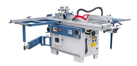
Die Formatkreissäge-Fräsmaschinen der PSM-Serie sind je nach Anwendung mit zwei verschiedenen Tischlängen lieferbar (2000 / 2600 mm). Serienmäßig ausgestattet mit 2 Motoren, einem Sägeblatt mit 315 mm für Schnitthöhen bis 100 mm, sowie einem Vorritzaggregat für ein ausreißfreies Bearbeiten von beschichteten Plattenwerkstoffen. Durch die großzügige Serienausstattung bieten diese Modelle außergewöhnliche Leistung und ein Maximum an Einsatzmöglichkeiten.
