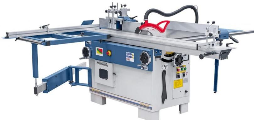
Die Formatkreissäge-Fräsmaschinen der PSM-Serie sind je nach Anwendung mit zwei verschiedenen Tischlängen lieferbar (2000 / 2600 mm). Serienmäßig ausgestattet mit 2 Motoren, einem Sägeblatt mit 315 mm für Schnitthöhen bis 100 mm, sowie einem Vorritzagggregat für ein ausreibefreies Bearbeiten von beschichteten Plattenwerkstoffen. Durch die großzügige Serienausstattung bieten diese Modelle außergewöhnliche Leistung und ein Maximum an Einsatzmöglichkeiten.
