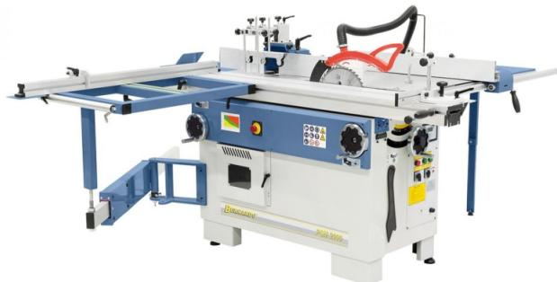
Die Formatkreissäge-Fräsmaschinen der PSM-Serie sind je nach Anwendung mit zwei verschiedenen Tischlängen lieferbar (2000 / 2600 mm). Serienmäßig ausgestattet mit 2 Motoren, einem Sägeblatt mit 315 mm für Schnitthöhen bis 100 mm, sowie einem Vorritzagggregat für ein ausreibfreies Bearbeiten von beschichteten Plattenwerkstoffen.
