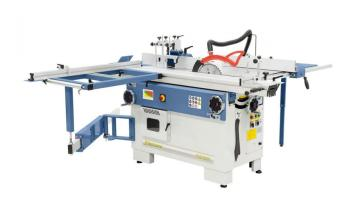
Die Formatkreissäge-Fräsmaschinen der PSM-Serie sind je nach Anwendung mit zwei verschiedenen Tischlängen lieferbar (2000 / 2600 mm). Serienmäßig ausgestattet mit 2 Motoren, einem Sägeblatt mit 315 mm für Schnitthöhen bis 100 mm, sowie einem Vorritzaggregat für ein ausreißfreies Bearbeiten von beschichteten Plattenwerkstoffen.
