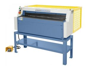
Die Bernardo PTS 1050 E Elektrische Präzisions-Tafelblechscheren ist ein hochpräzises Werkzeug für die Metallverarbeitung. Mit einer Schnittlänge von 1050 mm und einer maximalen Blechstärke von 1,0 mm bei 400 N/mm² ist sie ideal für präzise Schnitte. Der Schnittwinkel beträgt 3°, und der Hinteranschlag kann zwischen 0 und 500 mm eingestellt werden. Der Seitenanschlag misst 225 mm.
