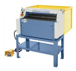
Die Bernardo PTS 650 E Elektrische Präzisions-Tafelblechscheren ist ein professionelles Werkzeug für die Metallverarbeitung. Mit einer Schnittlänge von 650 mm und einer maximalen Blechstärke von 1,25 mm bei 400 N/mm² ist sie ideal für präzise Schnitte. Der Schnittwinkel beträgt 3°, und der Hinteranschlag kann zwischen 0 und 500 mm eingestellt werden. Die Seitenanschlagweite beträgt 225 mm.
