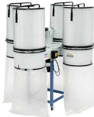
Das Modell DC 850 CF ist durch die in der Grundausrüstung enthaltenen Feinstaub-Filterpatronen noch leistungsfähiger (größere Filterfläche), dadurch filtert sie die Luft so effektiv, dass auch der gesundheitsschädliche Feinstaub in der Werkstatt auf ein Minimum reduziert wird.
