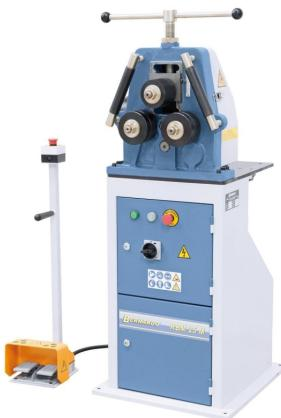
Die Bernardo RBM 25 M Motorische Ringbiegemaschinen sind zum Biegen von Rohren und Profilmaterialien aus Stahl, Aluminium, Messing usw. einsetzbar. Die Einstellung der Oberwalze erfolgt über eine leicht einsehbare mm-Skala. Serienmäßig mit Fußpedal zum Steuern des Rechts- und Linkslaufes. Sowohl horizontal als auch vertikal einsetzbar. Biegewalzen gehärtet und geschliffen.
