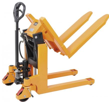
Der Bernardo HHK 1000 Manuelle Hochhubwagen ist ein vielseitiges Gerät für den Einsatz in verschiedenen Branchen. Mit seiner Tragkraft von 1000 kg und einer Gabellänge von 800 mm ist er ideal für den Transport von Gütern. Die Gabelbreite von 160 mm und die Gabellänge von 50 mm ermöglichen eine flexible Handhabung von verschiedenen Lasten.
