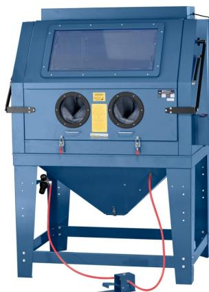
Die Bernardo SB 4 Sandstrahlkabinen sind für den Einsatz in verschiedenen Branchen konzipiert. Die Kabinen bieten eine Arbeitsraumabmessung von 1110 x 820 x 810 mm und sind für die Verwendung von Korngrößen zwischen 0,149 und 0,250 mm geeignet.
