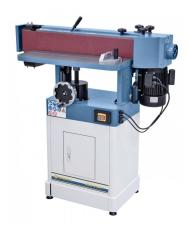
Die Kantenschleifmaschine KSM 2100 P ist serienmäßig mit einer Schleifbandoszillation und einem horizontal und vertikal schwenkbarem Schleifaggregat ausgestattet. Durch diese Ausstattungsmerkmale ist dieses Modell vielseitig einsetzbar und findet ihren Einsatzbereich vorwiegend beim fortgeschrittenen Heimwerker.
