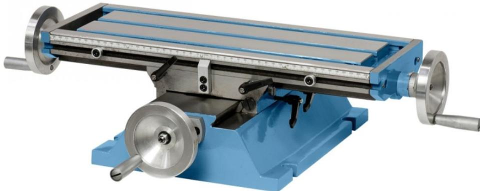
Der Bernardo Kreuztisch KT 500 x 180 ist ein Kreuztisch mit einer Tischlänge von 500 mm und einer Tischbreite von 180 mm. Die Traglast beträgt 40 kg. Der Tisch hat eine Länge von 633 mm, eine Breite von 473 mm und eine Höhe von 156 mm. Die T-Nutengröße beträgt 12 mm und es sind 3 Stück T-Nuten vorhanden.
