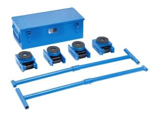
Der Bernardo SK 4 Schwerlast-Wälzwagenset ist ein hochwertiges Produkt für den professionellen Einsatz. Die Traglast beträgt maximal 4000 kg. Die Auflage hat einen Durchmesser von 90 mm und die Rollen einen Durchmesser von 18 mm und eine Breite von 51 mm. Der Handgriff ist 850 mm lang. Die Abmessungen der Auflage betragen vorne/hinten 154 x 102 x 90 mm. Das Gewicht des Sets beträgt etwa 21 kg.
