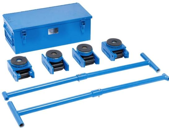
Der Bernardo SK 4 Schwerlast-Wälzwagenset ist ein hochwertiges Produkt für den professionellen Einsatz. Die Traglast beträgt maximal 4000 kg. Die Auflage hat einen Durchmesser von 90 mm und die Rollen einen Durchmesser von 18 mm und eine Breite von 51 mm. Der Handgriff ist 850 mm lang. Die Abmessungen der Auflage betragen vorne/hinten 154 x 102 x 90 mm. Das Gewicht des Sets beträgt etwa 21 kg.
