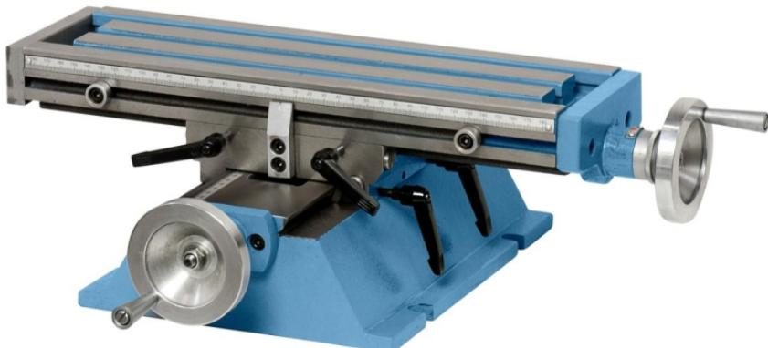
Der Bernardo Kreuztisch KT 400 x 120 ist ein vielseitiger Kreuztisch, der für verschiedene Anwendungen geeignet ist. Die Tischlänge beträgt 400 mm und die Tischbreite 120 mm. Der Tisch verfügt über drei T-Nuten mit einer Größe von 10 mm. Die Traglast des Tisches beträgt 55 kg.
