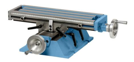
Der Bernardo Kreuztisch KT 400 x 120 ist ein vielseitiger Kreuztisch, der für verschiedene Anwendungen geeignet ist. Die Tischlänge beträgt 400 mm und die Tischbreite 120 mm. Der Tisch verfügt über drei T-Nuten mit einer Größe von 10 mm. Die Traglast des Tisches beträgt 55 kg.
