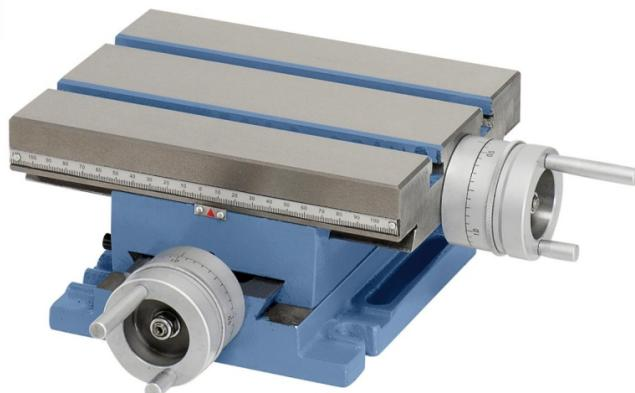
Der Bernardo Kreuztisch KT 225 x 175 ist ein Kreuztisch mit einer Tischlänge von 225 mm und einer Tischbreite von 175 mm. Die Traglast beträgt 40 kg. Der Tisch hat eine Länge von 325 mm, eine Breite von 325 mm und eine Höhe von 110 mm. Die T-Nutengröße beträgt 12 mm und es sind 2 Stück T-Nuten vorhanden.
