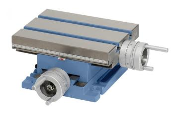
Der Bernardo Kreuztisch KT 225 x 175 ist ein Kreuztisch mit einer Tischlänge von 225 mm und einer Tischbreite von 175 mm. Die Traglast beträgt 40 kg. Der Tisch hat eine Länge von 325 mm, eine Breite von 325 mm und eine Höhe von 110 mm. Die T-Nutengröße beträgt 12 mm und es sind 2 Stück T-Nuten vorhanden.
