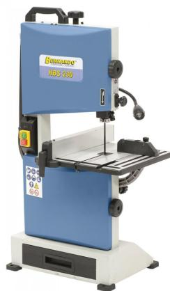
Die Holzbandsägen der HBS-Serie bieten eine großzügige Schnittleistung auf engstem Raum. Die Antriebsräder sind serienmäßig mit einer Spezialgummibandage ausgestattet, wodurch eine lange Lebensdauer der Sägebänder garantiert wird. Durch das optimale Preis-Leistungsverhältnis sind diese Maschinen die ideale Lösung für den Hobbybastler.
