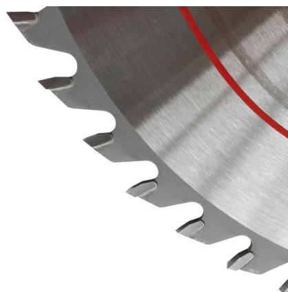
Das Holzmann KSB40034Z36 TCT Kreissägeblatt ist ideal für die Holzverarbeitung, professionellen und anspruchsvollen Industriegebrauch. Es verfügt über Hartmetallzähne in Industrie Qualität, die voll gehärtet, präzisionsgeschliffen und poliert sind. Durch die extra lange Lebensdauer und die Laserdehnfugen gegen thermischen Verzug ist es ein zuverlässiges Werkzeug für Ihre Anforderungen.
