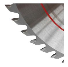
Hartmetallzähne in Industrie Qualität, voll gehärtet, präzisionsgeschliffen und poliert, ideal für die Holzverarbeitung, professionellen und anspruchsvollen Industriegebrauch, extra lange Lebensdauer, Laserdehnfugen gegen thermischen Verzug.
