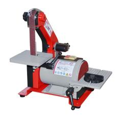
Der Holzmann BT75\_230V Band-Tellerschleifer ist vielseitig einsetzbar und zeichnet sich durch seine gleichbleibende Geschwindigkeit aus, was ihn ideal für Feinarbeiten macht. Der Schleiftisch ist schwenkbar und ermöglicht verschiedene Schleifwinkel. Der Schleifer ist ausgestattet mit einem kräftigen Induktionsmotor und inklusive Winkelanschlag.
