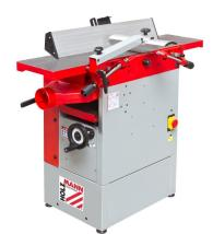
Die Holzmann HOB260ECO 230V Abricht-Dickenhobelmaschine bietet eine stabile Konstruktion und hohe Standsicherheit. Der Abrichtanschlag ist schwenkbar und die seitlich aufklappbaren Graugusstische ermöglichen komfortables Dickenhobeln. Ein Absauganschluss ermöglicht staub- und spänefreies Arbeiten. Der Vorschub ist wahlweise abschaltbar.
