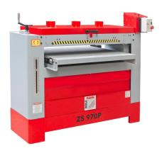
Die Holzmann ZS970P\_400V Zylinderschleifmaschine ist eine professionelle Schleifmaschine mit 970 mm Schleifbreite. 2 Schleifwalzen ermöglichen grobes und feines Schleifen in einem Durchgang. Die Maschine verfügt über einen qualitativ hochwertigen Vorschubteppich mit langer Lebensdauer und eine dynamisch gewuchtete Schleifwalze, die absolute Laufruhe garantiert.
