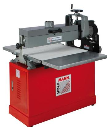
Die Holzmann ZS560U\_230V Zylinderschleifmaschine ist eine leistungsstarke Maschine für die Holzbearbeitung. Sie verfügt über eine abnehmbare Halterung für Werkstücke bis 1100 mm Breite und einen stufenlosen Vorschub über ein Potentiometer. Die Maschine hat eine stabile Gusskonstruktion des Schleifkörpers und ein geschlossenes Untergestell mit Schanksystem.
