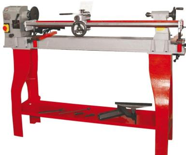
Die Holzmann VD1100N\_400V Drechselbank bietet variable Geschwindigkeit und ermöglicht vibrationsloses Arbeiten dank ihres schweren Gußuntergestells. Das Bett, Untergestell, Reitstock und Spindelstock bestehen aus massivem Grauguss. Der Spindelstock ist 90° drehbar, was Aussendrehen ermöglicht. Eine Kopiervorrichtung zum Kopieren von Originalen oder nach Schablonen ist ebenfalls vorhanden.
