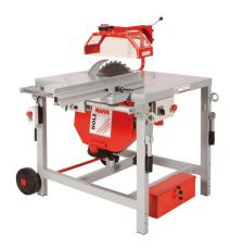
Die Holzmann TS400Z\_400V Zimmerer Tischkreissäge ist ideal für den Zimmereibedarf mit stabilem Sägeaggregat. Sie bietet eine einfach zu bedienende Sägeeinheit mit 90° Drehteller und simultan verstellbarem Sägeblatt (bis 45°) für verschiedenste Schnittarbeiten. Die Säge ermöglicht Kehl- und Gratsparen wie Trauf- und Keilbohlen Schnitte und bietet eine Anschlussmöglichkeit für eine Absaughaube, um Späne und Staub zu reduzieren.
