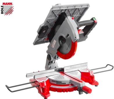
Die Holzmann TK305\_230V ist eine Kapp- Tisch- und Gehrungssäge mit Laser, die als Kappsäge oder Tischkreissäge verwendet werden kann. Der Rotationstisch ist 45° schwenkbar und das Sägeaggregat kann zwischen 0-45° geschwenkt werden. Die Maschine verfügt über einen robusten Aludruckguss-Sägetisch und einen Sicherheitsschalter, der vor versehentlichem Starten schützt. Sie kann auch mit einer externen Absauganlage verbunden werden.
