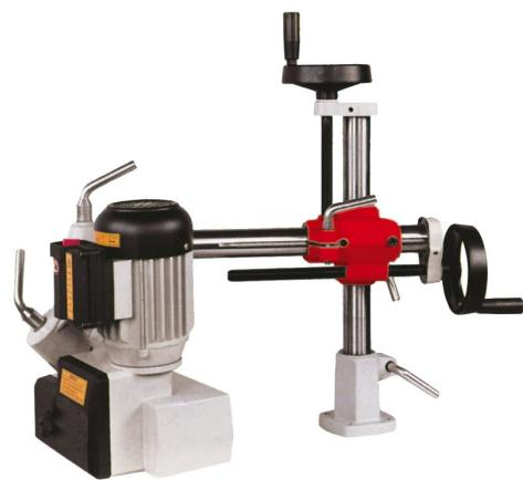
Der Holzmann SF324N\_230V Vorschubapparat ist ein hochpräzises Gerät mit 3 Antriebsrollen, das über ein Zweistangenstativ jede Arbeitsposition leicht einstellbar macht. Durch den Rechts/Links Lauf und das Präzisionsgetriebe wird eine exakt gleichmäßige Vorschubgeschwindigkeit und lange Lebensdauer gewährleistet.
