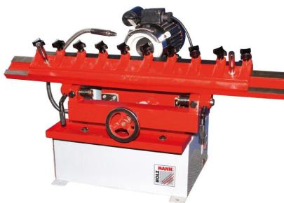
Die Holzmann MS7000\_230V Hobelmesserschärfmaschine ist eine solide und schwingungsfreie Konstruktion, die optimale Schärferegebnisse ermöglicht. Sie ist geeignet für Hobelmesser bis 630mm Länge und verfügt über ein einfaches und effizientes Spannsystem. Jeder Schnittwinkel des Hobelmessers ist einstellbar.
