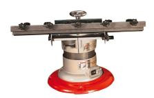
Die Holzmann MS6000\_230V Universal Schärfmaschine ist speziell geeignet für Hobelmesser bis 600mm und auch zum Schärfen von Bohrern und Stemmeisen. Das massive Untergestell sorgt für erhöhte Präzision. Der Schleifstein ist über Handrad höhenverstellbar und die Schiene über Einstellag für unterschiedliche Schneidenwinkel einstellbar. Die einfache Handhabung bei höchster Effizienz macht diese Maschine zu einem wertvollen Werkzeug.
