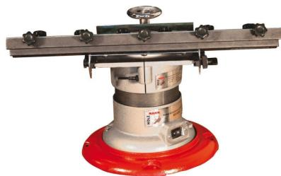
Die Holzmann MS6000\_230V Universal Schärfmaschine ist speziell geeignet für Hobelmesser bis 600mm und auch zum Schärfen von Bohrern und Stemmeisen. Das massive Untergestell sorgt für erhöhte Präzision. Der Schleifstein ist über Handrad höhenverstellbar und die Schiene über Einstellrad für unterschiedliche Schneidenwinkel einstellbar. Die einfache Handhabung bei höchster Effizienz macht diese Maschine zu einem wertvollen Werkzeug.
