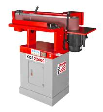
Die Holzmann KOS2260C\_400V Kantenschleifmaschine oszillierend ermöglicht ein perfektes Schleifergebnis sowie optimale Ausnutzung der gesamten Schleifbandfläche. Durch die oszillierende Bewegung und die stufenlose Höhenverstellung des Gussschleiftisches kann das Schleifergebnis optimal angepasst werden. Das Schnellspannsystem ermöglicht eine schnelle Aus- und Umwechslung des Schleifbandes.
