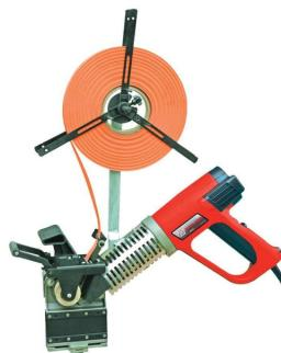
Das Holzmann KAM50M\_230V Kantenanleimgerät ist zum Anleimen von schmelzkleberbeschichteten Kanten aus Furnier, Kunststoff usw. geeignet. Es verfügt über Führungsbacken, die stufenlos auf die Materialbreite einstellbar sind, und ist für runde und gerade Werkstücke gleichermaßen geeignet. Die sehr saubere Alu-Druckgussverarbeitung sorgt für eine hohe Qualität.
