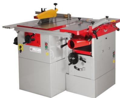
Die Holzmann K5260L\_230V ist eine kompakten Multifunktionsmaschine mit optimalem Preis-Leistungsverhältnis, ideal für ambitionierte Heimwerker. Die Auswahl der Funktion erfolgt komfortabel über einen Drehschalter. Drei starke Motoren sorgen für ausreichende Leistung.
