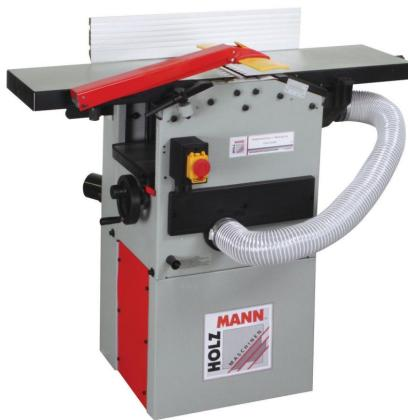
Die Holzmann HOB260ABS\_400V Abricht-Dickenhobelmaschine ist eine Kombimaschine mit integrierter Absaugung. Sie kann für Abrichten und Dickenhobeln verwendet werden. Der Abrichttisch ist aus solidem Alu-Druckguss und hat eine Größe von 1050x260 mm. Die Maschine verfügt über einen schwenkbaren Aluminium-Abrichtanschlag und einen Absaugsack zum einfachen Wechseln.
