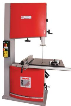
Die Holzmann HBS700\_400V Holzbandsäge zeichnet sich durch besonders hochwertige und qualitative Verarbeitung aus. Gummierte und präzisionsgelagerte Laufräder ermöglichen geräuscharmen Betrieb. Der Aluminiummanschlag mit Schnellverschluss und die Maßskala am Anschlag mit 2 Lupen zum genauen Ablesen und Einstellen sind weitere Highlights.
