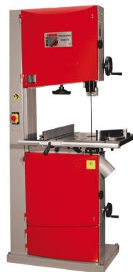
Die Holzmann HBS470PROFI\_230V Holzbandsäge ist für den professionellen Einsatz mit Gussantriebsräder konzipiert. Gummierte und präzisionsgelagerte Gußspeichenlaufräder ermöglichen geräuscharmen Betrieb. Der Aluminiummanschlag mit Schnellverschluss und die Maßskala am Anschlag sowie die Lupe zum genauen Ablesen und Einstellen erleichtern die Arbeit.
