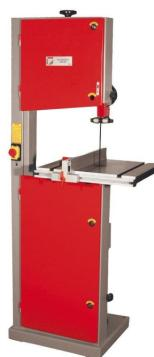
Die Holzmann HBS400\_400V Holzbandsäge ist eine präzise und robuste Maschine für die Holzbearbeitung. Sie verfügt über eine Präzisionssägebandführung mittels Handrad und Zahnstange, die exakt positionierbar ist. Der Aluminiumanschlag mit Maßskala und Schnellverschluss ermöglicht eine einfache und genaue Einstellung. Die Sägebandbreite kann zwischen 6mm und 20mm variieren.
