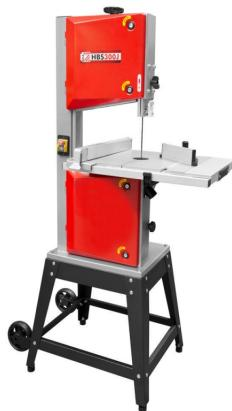
Die Holzmann HBS300J\_230V Holzbandsäge ist eine präzise und leistungsstarke Maschine für die Holzbearbeitung. Der Graugusstisch ist bis 45° nach vorne schwenkbar und bietet eine präzise geschliffene und polierte Oberfläche. Die Laufrollen aus Alu-Druckguss mit spezieller Gummibeschichtung sorgen für eine lange Lebensdauer des Bandsägeblattes.
