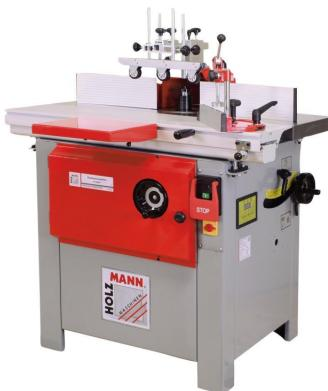
Die Holzmann FS200SF\_230V Fräsmaschine bietet eine große Arbeitsfläche dank massivem und verwindungsfreiem Graugusstisch sowie leichtgängigem Aluminiumformattisch mit Tischausleger. Die Maschine verfügt über 4 Fräsgeschwindigkeiten, eine bis 45° nach hinten schwenkbare Frässpindel und einen Wahlschalter für Rechts- bzw. Linkslauf der Frässpindel.
