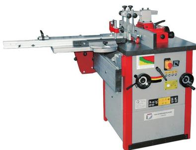
Die Holzmann FS200S\_230V Fräsmaschine ist eine leistungsstarke Maschine für die Holzbearbeitung. Sie verfügt über eine schwenkbare Frässpindel, einen massiven und verwindungsfreien Graugusstisch sowie einen hochwertigen Fränsanschlag mit Niederhaltersystem und Feinjustierung. Die Maschine bietet 4 Fräsgeschwindigkeiten und einen maximalen Fräserdurchmesser von 200mm.
