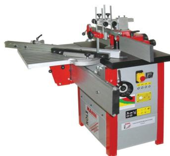
Die Holzmann FS200\_400V Fräsmaschine ist eine hochwertige Maschine für die Holzbearbeitung. Sie verfügt über einen massiven und verwindungsfreien Graugusstisch, einen hochwertigen Fräsantrieb mit Niederhaltersystem und Feinjustierung sowie 4 Fräsgeschwindigkeiten. Die maximale Fräserdurchmesser beträgt 200mm und die Geschwindigkeit ist über eine LED-Anzeige ablesbar. Die Maschine verfügt auch über große Handräder zur Spindelverstellung und einen Schleifaufsaß, der im Lieferumfang enthalten ist.
