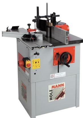
Die Holzmann FS160L\_230V Fräsmaschine ist eine Tischfräsmaschine mit massivem, verwindungsfreiem Graugusstisch und Alu-Formatschiebetisch (1000x215mm). Sie bietet viele Anwendungsmöglichkeiten trotz kompakter Bauweise und geringem Platzbedarf. Die dynamisch ausgewichtete Frässpindel sorgt für präzisen Lauf. Das Gerät verfügt über eine beidseitig bis 60° schwenkbare Gehrungsanschlag, einen Klappanschlag und einen Niederhalter für Gehrungs- und Querfräsen.
