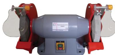
Der Holzmann DSM250\_230V Doppelschleifbock ist eine Industrieausführung, die für Dauereinsatz geeignet ist. Er verfügt über einen wartungsfreien Induktionsmotor und einen Nullspannungsauslöser. Das hochwertige und schwungsgesärmte Druckgussgehäuse sowie die Präzisionslagerung optimieren das Schleifergebnis. Der Plexiglassichtschutz mit Lupenfunktion ermöglicht eine gute Sicht auf das Arbeitsstück.
