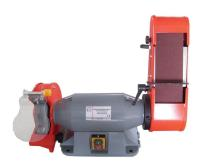
Der Holzmann DSM100200B\_400V Doppelschleifbock mit Schleifband ist eine Industrieausführung, die für verschiedene Schleifarbeiten konzipiert ist. Die Universalschleifbänder sind 915x100mm groß und haben eine Körnung von 80. Der Schleifbandträger ist individuell von 0° - 90° einstellbar, und die Werkstückaufnahme ist bis 45° schwenkbar. Der einfache Bandwechsel erfolgt mittels Einhandspannhebel.
