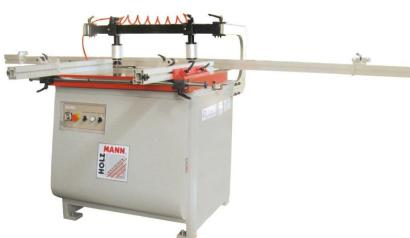
Die Holzmann DBM21N\_400V Dübelbohrmaschine ist ideal für Eck- und Rahmenverbindungen sowie Bohrungen für Schrankbeschläge. Das Bohrgerät ist pneumatisch 0°- 45°- 90° schwenkbar zum stirn- und flächenseitigen Bohren. Die Maschine verfügt über 2 Pneumatikspannmodule und ein Fußpedal zum Spannen, Bohren und Lösen.
