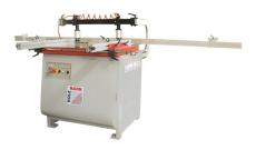
Die Holzmann DBM21N 400V Dübelbohrmaschine ist ideal für Eck- und Rahmenverbindungen sowie Bohrungen für Schrankbeschläge. Das Bohraggregat ist pneumatisch 0°- 45°- 90° schwenkbar zum stirn- und flächenseitigen Bohren. Die Maschine verfügt über 2 Pneumatikspannmodule und ein Fußpedal zum Spannen, Bohren und Lösen.
