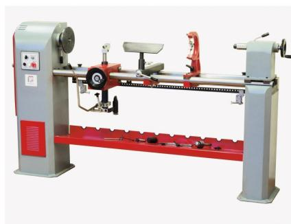
Die Holzmann DBK1500\_400V Drechselbank mit Kopiervorrichtung ist eine massive und verwindungsfreie Stahlkonstruktion. Sie bietet eine praktische Einhandbedienung mit Exzenterspanntechnik und einen robusten Reitstock mit Doppelführung und Zentrierung durch Rundstahlführung. Die Maschine verfügt über eine M33 Spindelaufnahme, MK2 Aufnahme des Reitstocks und der Hauptspindel sowie eine große Handauflage mit Schnellfixierung und stufenloser Höheneinstellung.
