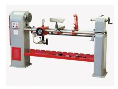
Die Holzmann DBK1500 400V Drechselbank mit Kopiervorrichtung ist eine massive und verwindungsfreie Stahlkonstruktion. Sie bietet eine praktische Einhandbedienung durch Rundstahlführung. Die Maschine verfügt über eine M33 Spindelaufnahme, MK2 Aufnahme des Reitstocks und der Hauptspindel sowie eine große Handauflage mit Schnellfixierung und stufenloser Höheneinstellung.
