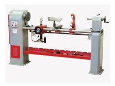
Die Holzmann DBK1300F 400V Kopierdrechselbank mit Frequenzumformer ist eine massive und verwindungsfreie Stahlkonstruktion. Sie bietet eine praktische Einhandbedienung mit Exzenterspanntechnik und einen robusten Reitstock mit Doppelführung und Zentrierung durch Rundstahlführung. Die M33 Spindelaufnahme, MK2 Aufnahme des Reitstocks und der Hauptspindel sowie die große Handauflage mit Schnellfixierung und stufenloser Höheneinstellung zeichnen diese Maschine aus. Links-, Rechtslauf ist serienmäßig.
