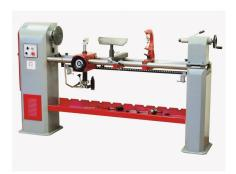
Die Holzmann DBK1300\_230V Drechselbank mit Kopiervorrichtung ist eine massive und verwindungsfreie Stahlkonstruktion. Sie bietet eine praktische Einhandbedienung mit Exzenterspanntechnik und einen robusten Reitstock mit Doppelführung und Zentrierung durch Rundstahlführung. Die Maschine verfügt über eine M33 Spindelaufnahme, MK2 Aufnahme des Reitstocks und der Hauptspindel sowie eine große Handauflage mit Schnellfixierung und stufenloser Höheneinstellung.
