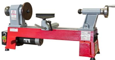
Die Holzmann D460F\_230V Drechselbank bietet eine Vielzahl von Funktionen für eine präzise und effiziente Bearbeitung von Holz. Mit einer Spitzenweite von 460 mm und einer Spitzenhöhe von 130 mm ermöglicht sie die Bearbeitung von großen und kleinen Werkstücken. Die Drehspindeldrehzahl kann in drei Stufen eingestellt werden: 650-1450, 1250-2800 und 1600-3800 min-1.
