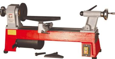
Die Holzmann D460\_230V Drechselbank ist eine leistungsstarke Maschine für verschiedene Anwendungen. Sie verfügt über eine Spindelaufnahme M33 DIN800, ein Bett, Reitstock, Handauflage und Spindelstock aus massivem Grauguss. Der MK2 Reitstock mit Schnellfixierung und die hohe Laufruhe durch POLY-V-Riemen Antrieb ermöglichen präzise Arbeiten. Die extralange Handauflage von 300mm mit Schnellfixierung und die Reitstockschnellverstellung bieten weitere Vorteile.
